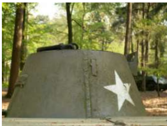
Svár na zadní části věže, vlevo patrný pozorovací průzor, napravo držák přídatného světlometu.
